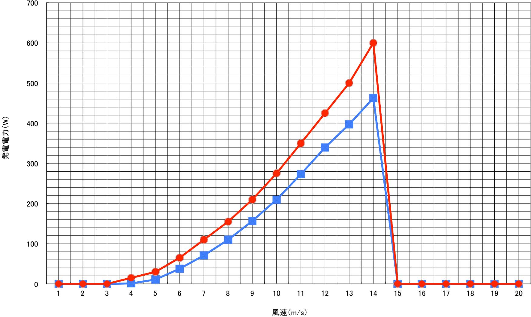
AD-600 風速(低風速) vs 発電電力(1~5m/s)
